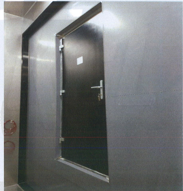
<사진 4> 저온측 시험체 모습 (열관류율)
