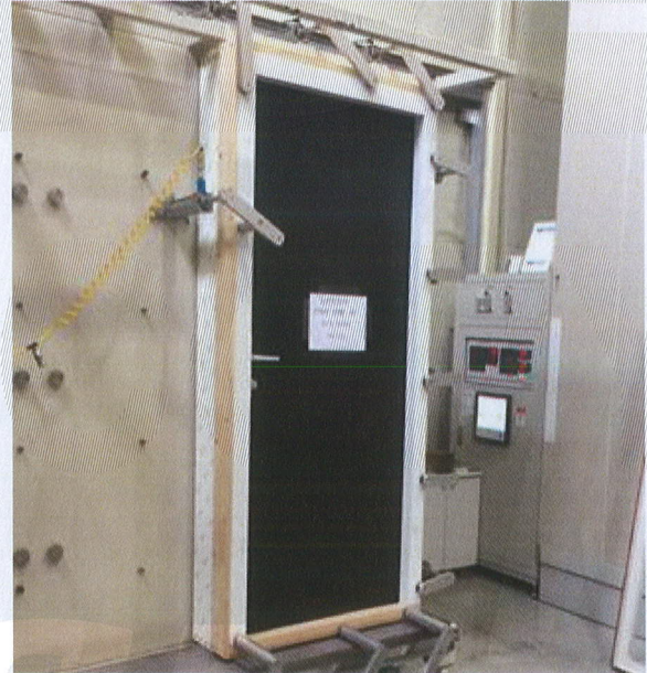
<사진 2> 시험체 측면 (기밀)
