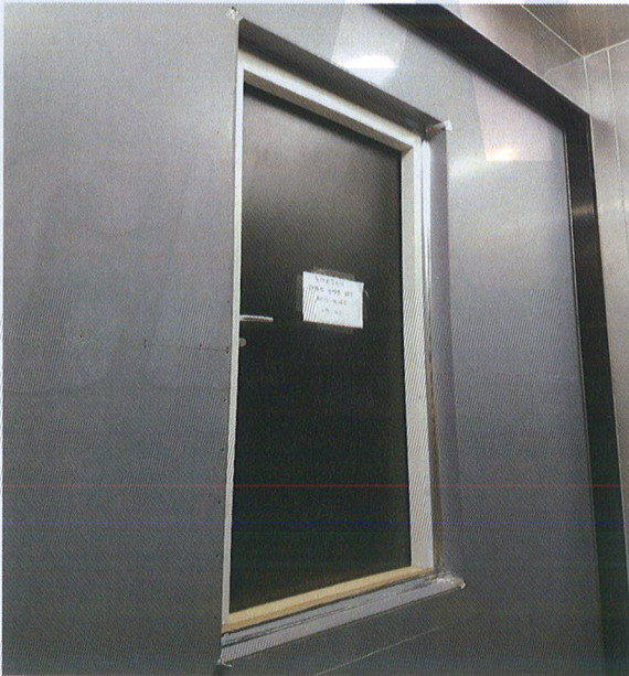
<사진 3> 상온측 시험체 모습 (열관류율)
