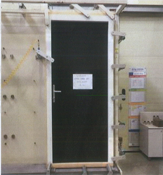
<사진 1> 시험체 정면 (기밀)
